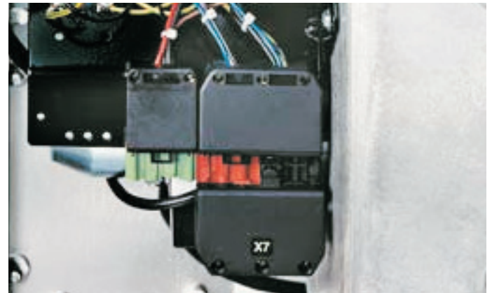
RLS 28-38 serisi brülörlerdeki elektrik bağlantı bloğu örneği
